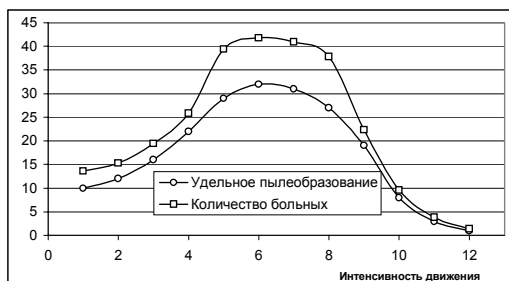
Рис. 1. Зависимость удельного пылеобразования (кг пыли / м³) и заболеваемости жителей придорожных деревень (сколиоз, случаев/год на 1000 жителей) от интенсивности движения гужевого транспорта (телег/час).
